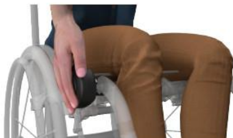
Tlačidlo podržte zatlačené najmenej po dobu 1,5 sekundy
